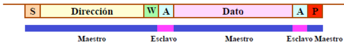
Figura 10-2. Protocolo I2C Maestro-Esclavo
