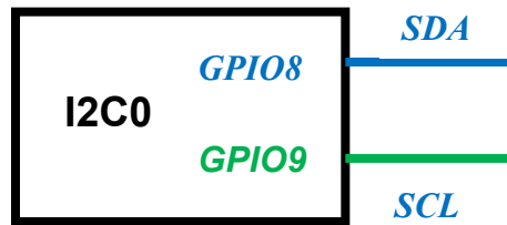
Figura 10-7. Asignación de terminales I2C
