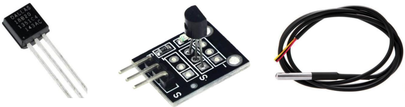
Figura 9-6. Versiones disponibles, sensor de temperatura DS18B20
