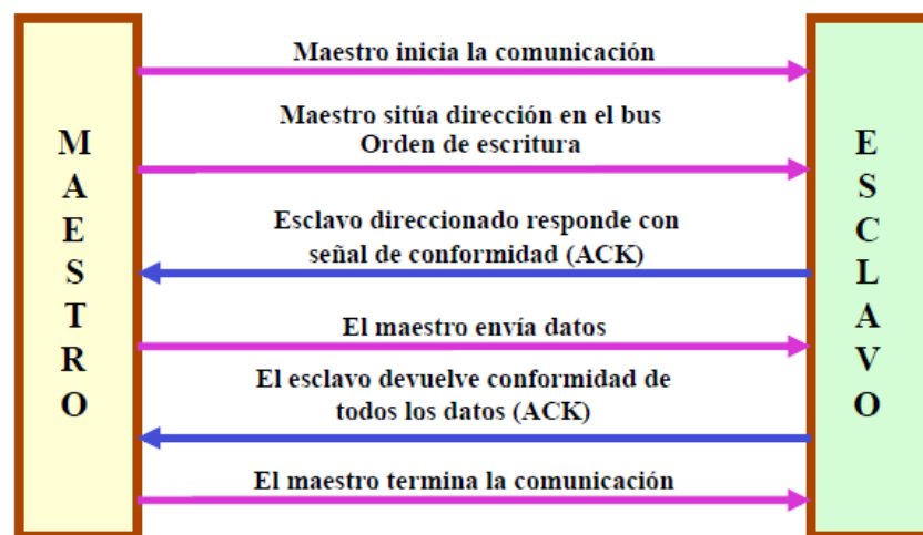
Figura 10-3. Algoritmo I2C.
