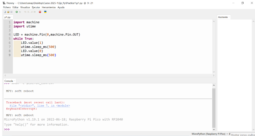
Figura 3-10. Detener ejecución y en espera
